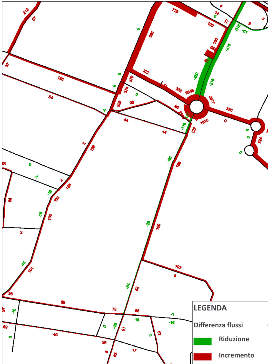
Img. 2.1.36 - Differenza fra i flussi nello Scenario B e nello scenario Tendenziale durante l'ora di punta del mattino
