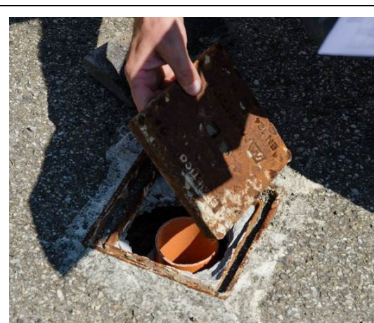
Foto 25 – Piezometro a tubo aperto installato nel 2010 all'interno del sondaggio S8/30/PZ (Img.2.4.12), ubicato nell'angolo sud-ovest del sito, nelle vicinanze del fabbricato Deposito sale sofisticato.
