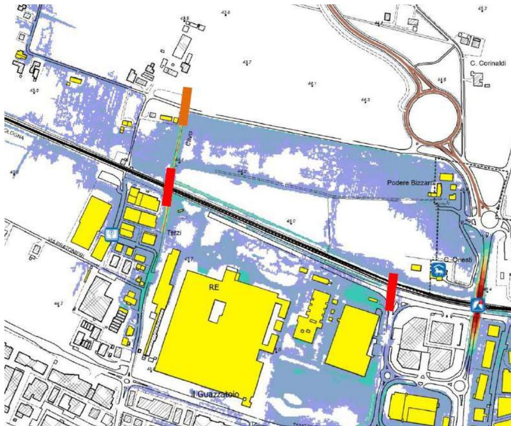
Sottopassi ferroviari di canali di bonifica. Attraverso questi passaggi le acque sono trasferite a nord della ferrovia, verso la zona in cui si troverà la nuova tangenziale. (fossetta Baratto – San Giulio equivalente circa DN 600 mm cls; fossetta Malaspina equivalente di un DN 1200-1500 cls; Guazzatore equivalente di uno scatolare 3000 x 2000 mm cls)
