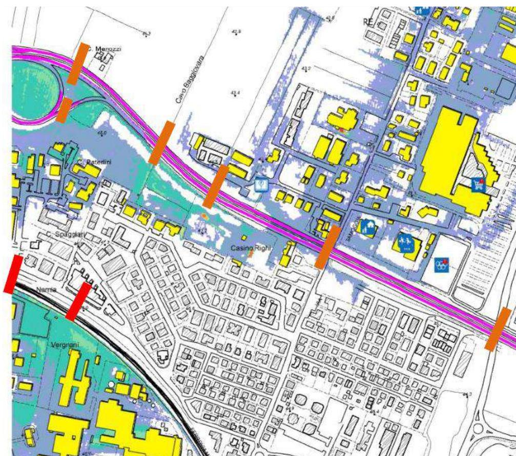
**Sottopassi ferroviari di canali di bonifica. Attraverso questi passaggi le acque sono trasferite a nord della ferrovia, verso la zona in cui si troverà la nuova tangenziale. (DN da 500 a 1000 mm in cls)**
